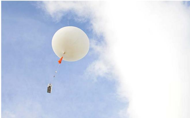
Los globos meteorológicos o globos-sonda son uno de los instrumentos que se emplearán como parte del proyecto OTREC para la caracterización de la atmósfera.
