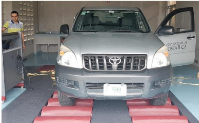
El dinamómetro instalado en la Escuela de Ingeniería Mecánica puede utilizarse para simular ciclos de conducción y analizar el comportamiento de los vehículos sometidos a ellos..
